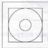
Кнопка включения средств пожарной автоматики
